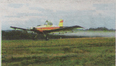
Micronair AU5000 instalado em um Ipanema EMB-201A pulverizando arroz.
