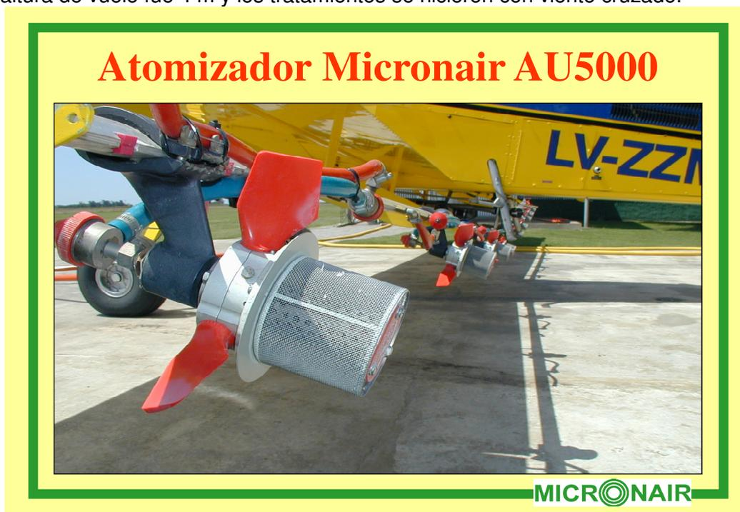
Figura 1 – Aeronave AT 502 equipada con 9 atomizadores Micronair AU 5000
